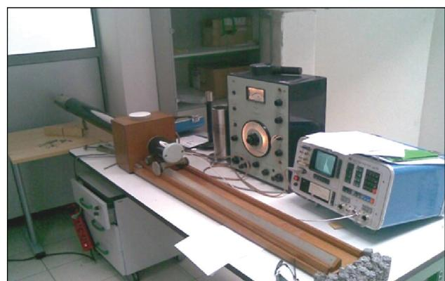
*Slika 10. Akustička ispitivanja malih uzoraka*
