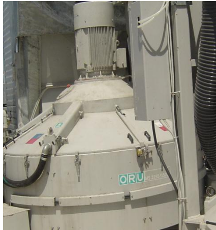
Slika 2 Mješalica za izradu laganog betona s dodatkom gumenih granula
